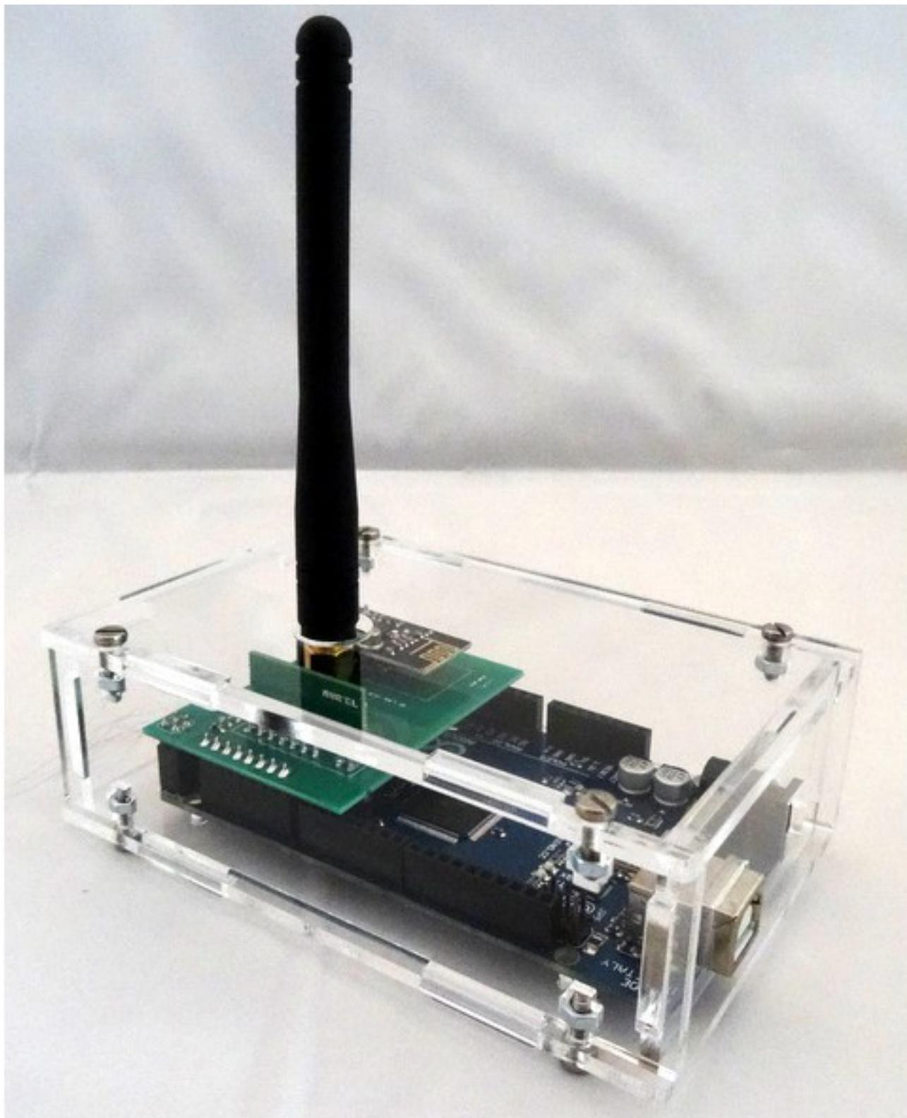
RFLink gateway는 RF 디바이스들을 위한 gateway이다. 주로 433Mhz를 사용하는 기기들을 지원하지만 이외에도 315Mhz, 866Mhz, 915Mhz 및 2.4Ghz 사용하는 몇몇 디바이스들도 지원해준다. RF signal을 송/수신 할 수 있으므로, 433Mhz 기반의 온습도계의 데이터를 읽거나, 433Mhz 기반의 AC switch를 제어하는 데 사용할 수 있다.
